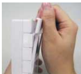
Verwijder de frontkap van de thermostaat
