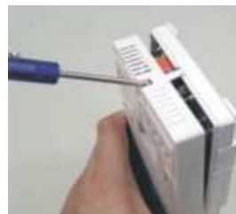
Kantel de schroevendraaier en druk voorwaarts. Hierdoor wordt de voorzijde losgenomen van de achterzijde.
