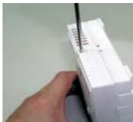
Druk voorzichtig middels een schroevendraaier de pin in.
