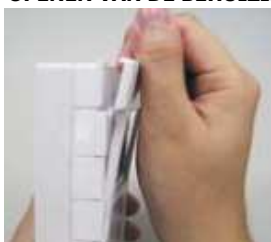
Verwijder de frontkap van de thermostaat.
