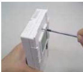
Verwijder twee schroeven: 1: bovenzijde thermostaat. 2: in de batterij houder.
